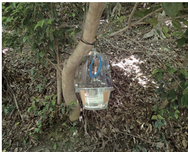
写真3 カシノナガキクイムシ成虫を誘引捕獲するフェロモントラップの設置状況
