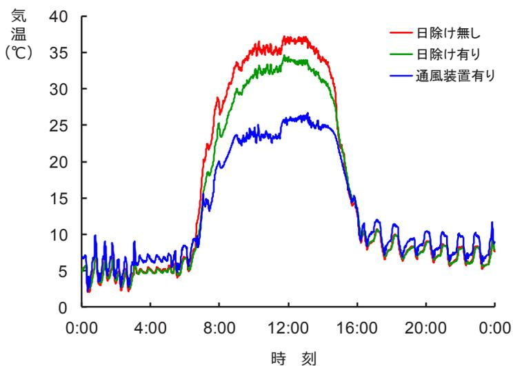
直射日光はセンサー自体を温めるため、晴天時には気温を実際よりも高く計測します。
