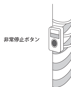
図4 転落防止設備例（非常停止ボタン）
