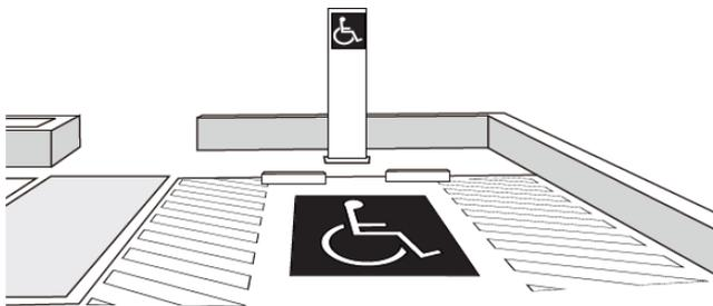
図4 車椅子使用者用駐車区画寸法の考え方（1台駐車）
