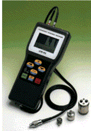
図-1 超音波厚さ計の一例
