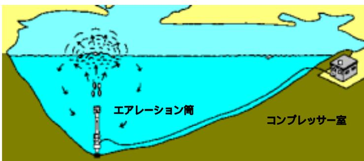
(原理) 揚水筒の下部から大きな泡を断続的に発生させ、筒内の水を一気に押し上げることにより、浅い所の水と深い所の水の入れ替えを図り、水面付近の水温を下げるとともに、表面の藻類を光の届かない所に送り込むことにより、藻類の増殖を抑制しようというものです。
