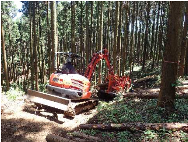
作業道を活用した林業機械による搬出作業
