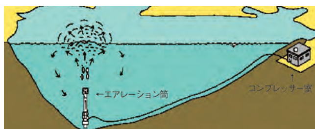
間欠式空気揚水筒式エアレーション装置概要図
