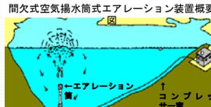
間欠式空気揚水筒式エアレーション装置概要
