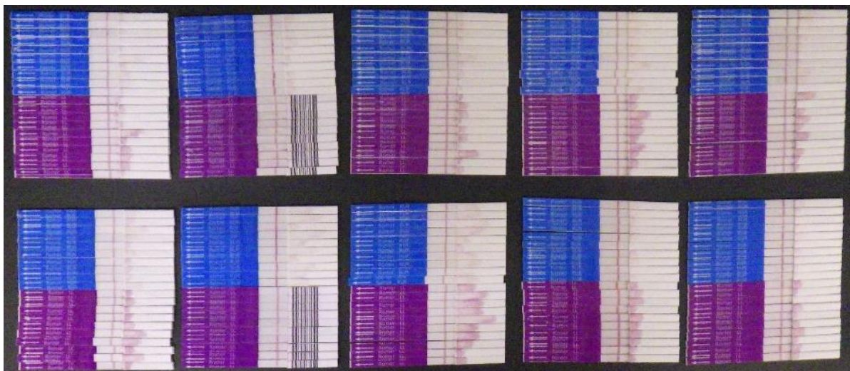
図2 免疫クロマトグラフ法による除草剤耐性タンパク質の検出結果(津久井在来)
