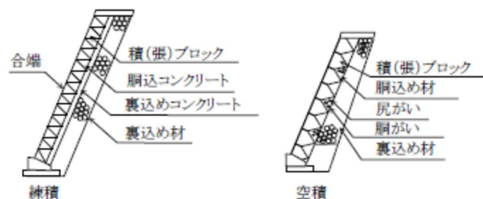
図 3-2-5 コンクリートブロック工
