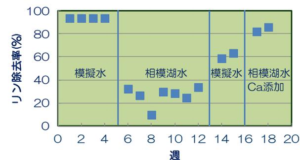
図 11 晶析脱リン法の連続試験結果
