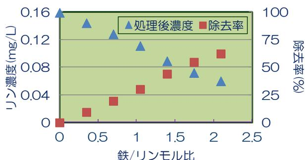
図3 鉄によるリンの除去効果
