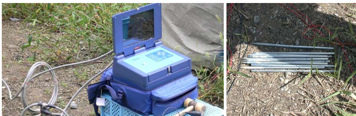
図 2 電気探査測定器と電極
