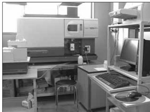
写真3 カドミウム・鉄などの重金属類を測定する誘導結合プラズマ発光分析装置
