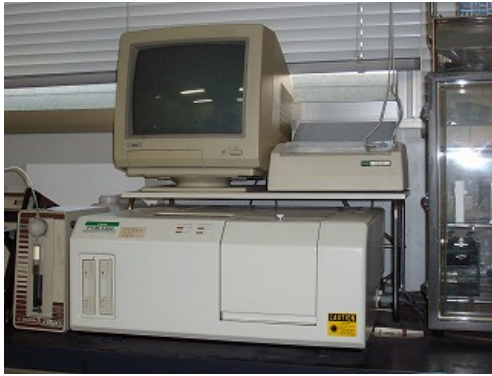
図2 赤外分光光度計 (FTIR)
