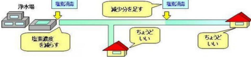
送水途中で不足分の次亜を追加補給することで、浄水場で注入する塩素濃度が低く抑えられるため、浄水場近くでもおいしい水が供給することができます。
