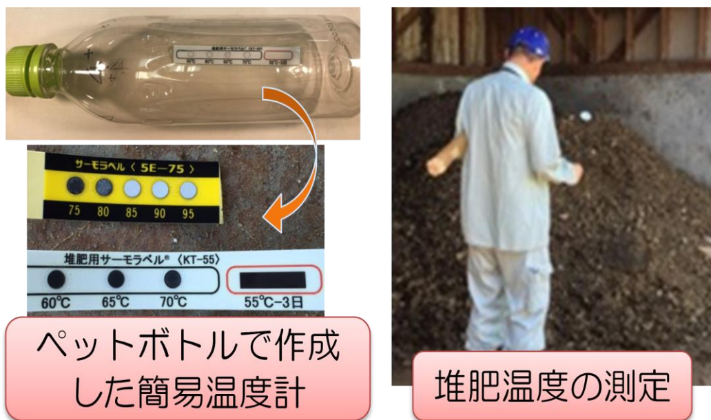
写真2 簡易温度計および堆肥温度測定の様子
