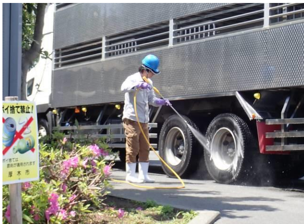
写真1 動力噴霧器による車体消毒を強化
