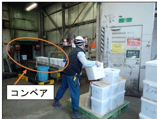
写真5 コンベアへの密閉容器の積載
