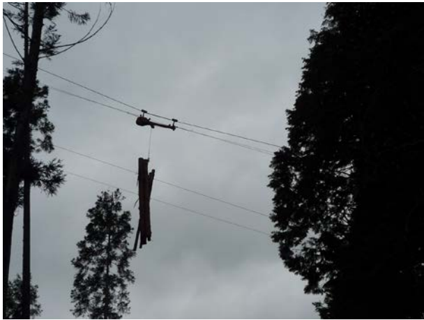
架線集材による間伐材搬出
