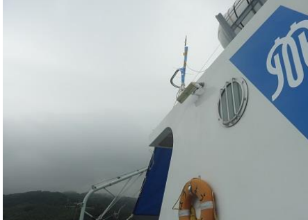
ほうじょう屋上に取り付けたアンテナ
