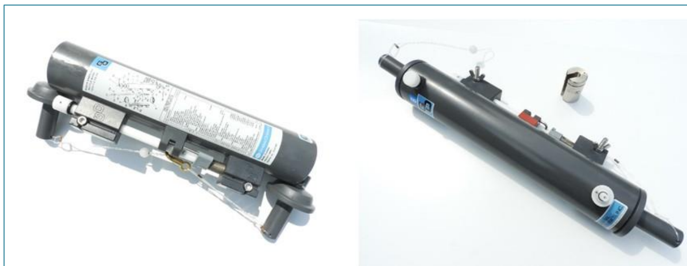
写真1 ニスキン採水器をセットしたところ（左）と閉じたところ及びメッセンジャー（右）
