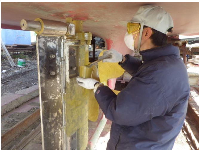
機関長による研磨後の塗装作業
