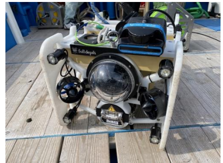
水中ドローン（300mまで潜水可能）
