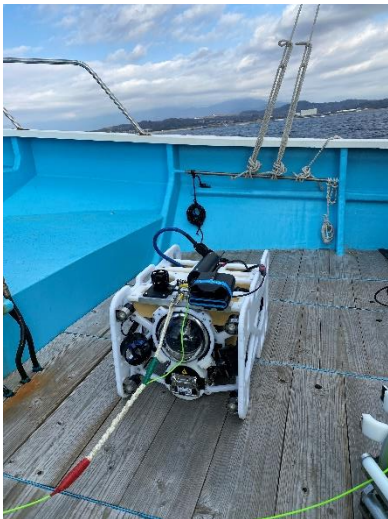
図1 細いケーブルで潮流の抵抗が少ないのが特徴の DiveUnit300
