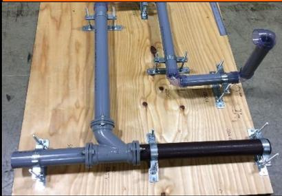
合成樹脂管や鋼管など、各種配管材の接合加工法を学びます。
