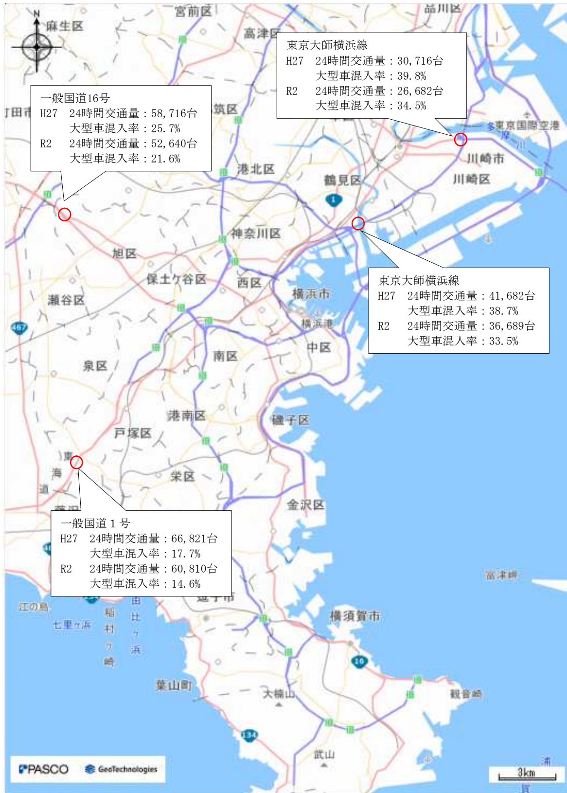
図3-5 幹線道路における交通量及び大型車混入率の比較
