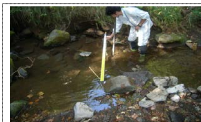
⑪水環境モニタリング フチジリ沢試験流域の水文観測地点の流量調査を行った。(南足柄市苅野)
