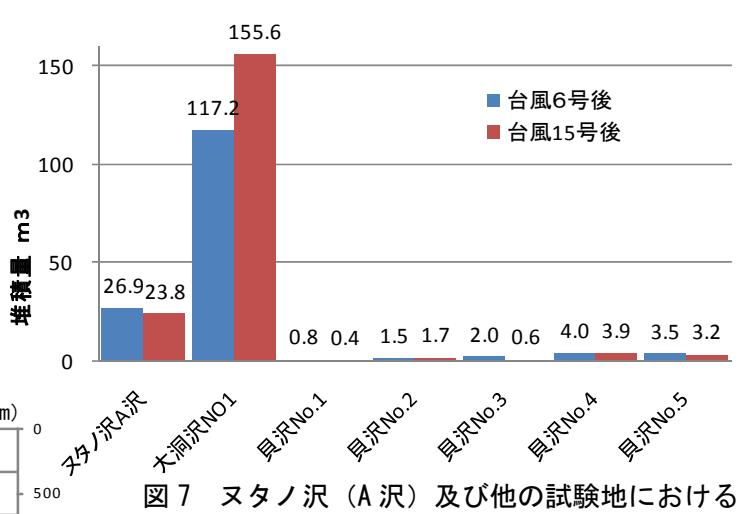
図7 ヌタノ沢(A沢)及び他の試験地における平成23年台風6号、15号による土砂流出量
