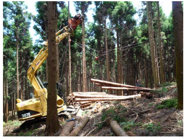
高性能林業機械による間伐材搬出
