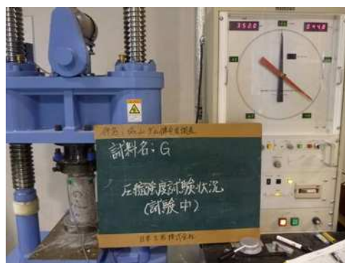
コンクリート試験片を用いた圧縮試験
