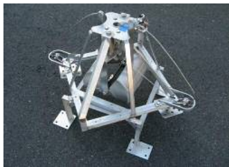
スミスマッキンタイヤ型採泥器 (採泥面積0.05m 2 )
