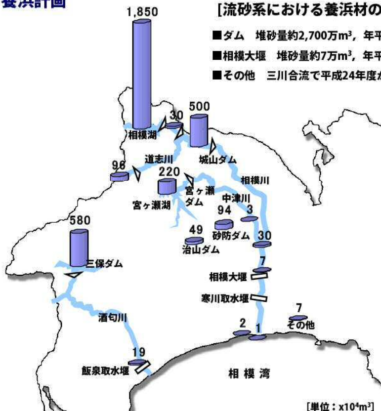
図-7 流砂系における養浜材の供給源
