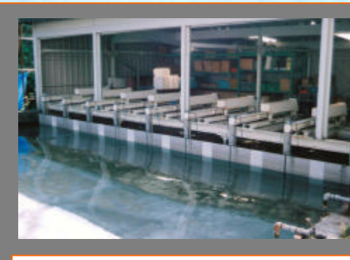
造波装置 造波能力：周期 0.5～4.0 秒 最大波高 15cm 程度 適用水深 10～35cm
