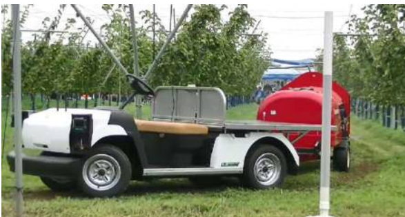
図8 ジョイントV樹形園内を走行する自動走行車と牽引式薬剤散布機
