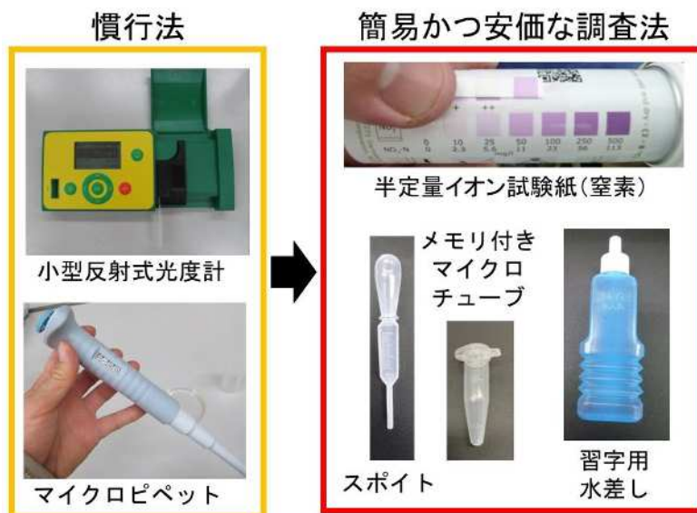
図1 半定量イオン試験紙を用いた簡易分析方法
