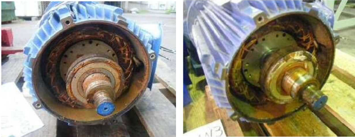
図-2.13 2013/4/9の水位上昇により発生した発電機内部のサビ状況
