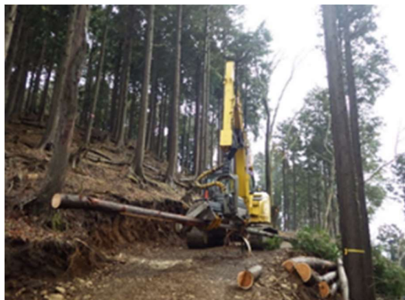
(写真) ハーベスタによる伐倒・枝払い・玉切り
