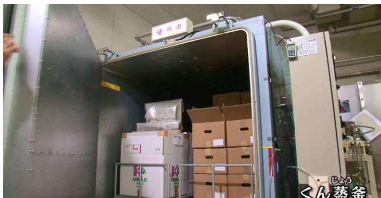
燻蒸釜 一回の燻蒸で約4000冊の書籍を燻蒸可能。
