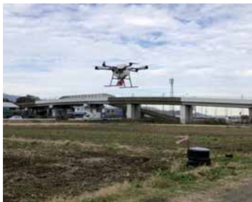
ドローンによる 周辺飛散の現地確認試験
