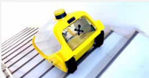
やわらかに階段昇降し荷物運搬できるソフトロボット
