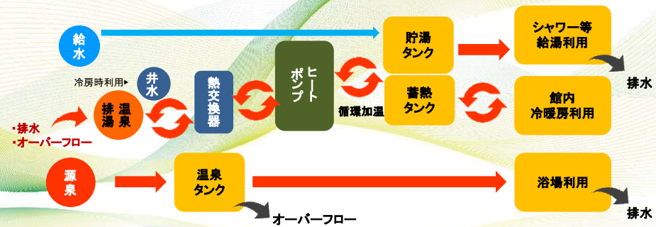
◇温度差利用ヒートポンプシステムフロー図
