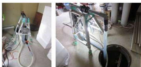
ポンプ・マルチサイクル試験状況
