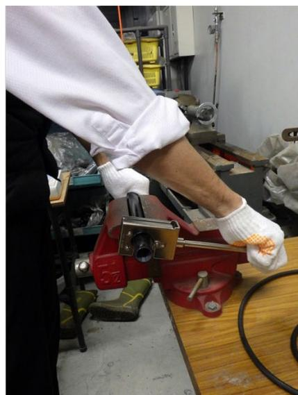
パイプの切出し：万力でパイプを固定し、ハンドカッターでパイプを挟みレバーを回転
