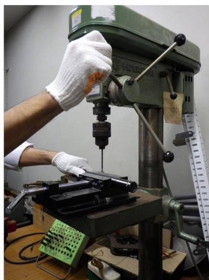
穴あけ：バイスでパイプを固定し、ボール盤のレバーを下げる
