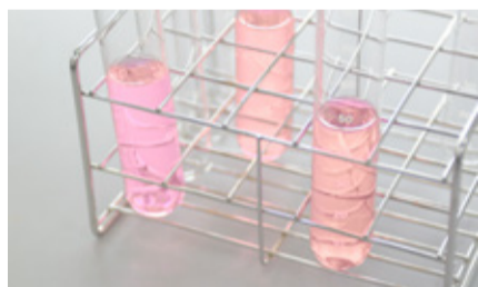
安全な水道水はDPD試薬という薬を入れると薄いピンクになります。
