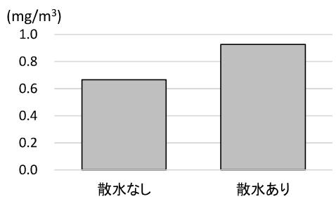
図 3 換気扇排気中の粉塵重量
