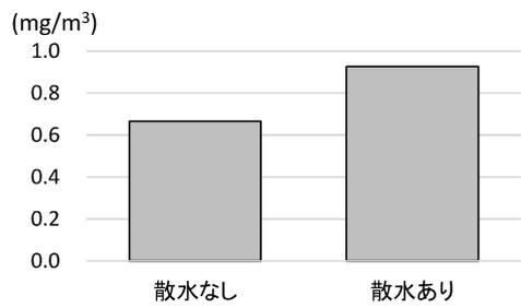
図3 換気扇排気中の粉塵重量
