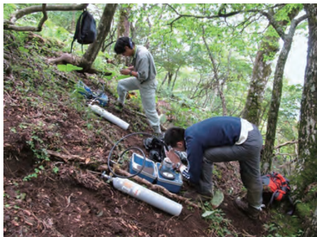
檜洞丸でのプレッシャーチャンバー法による葉の水ポテンシャル測定（京都府立大学） 山岳地帯での測定には装置の重量が重く、運搬の負荷が大きい。
