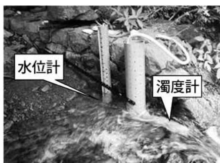
写真1 ワサビ沢に設置した水位計、濁度計
