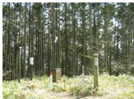
左：貝沢のイオン交換樹脂バツクの設置状況（土壌深 0cm） 東京農工大学撮影（H 21）
