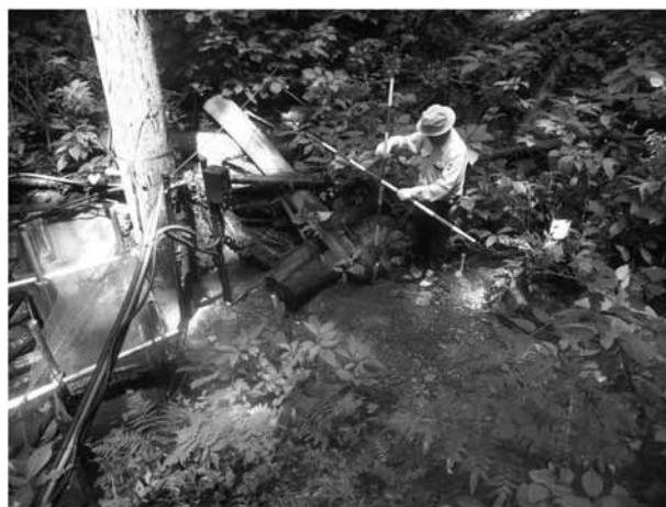
写真8 貝沢No.1 水文観測地点の量水堰の土砂堆積状況 (平成23年8月5日撮影)
