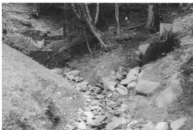
写真2 A沢(左奥)およびB沢(右手前)の量水堰 (A沢とB沢の合流部)
