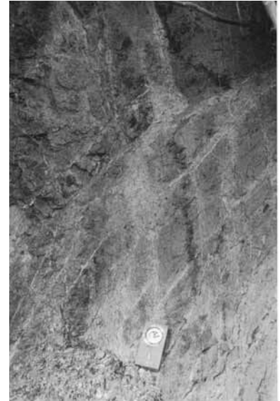
写真5 A沢左岸（調査孔下）の露頭（③付近） (節理：N60° E、90°と小断層)
