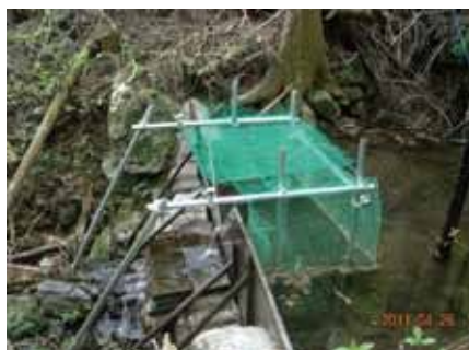
左：貝沢のイオン交換樹脂バツクの設置状況（土壌深 0cm） 東京農工大学撮影（H 21） 中央：貝沢のNo.1 量水堰の落葉除けネット設置状況、 東京農工大学撮影（H 23） 右：貝沢の尾根に設置したNo.2 気象観測装置 自然環境保全センター撮影（H 24）
