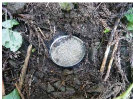
左：貝沢のイオン交換樹脂バツクの設置状況（土壌深 0cm） 東京農工大学撮影（H 21） 中央：貝沢のNo.1 量水堰の落葉除けネット設置状況、 東京農工大学撮影（H 23） 右：貝沢の尾根に設置したNo.2 気象観測装置 自然環境保全センター撮影（H 24）
